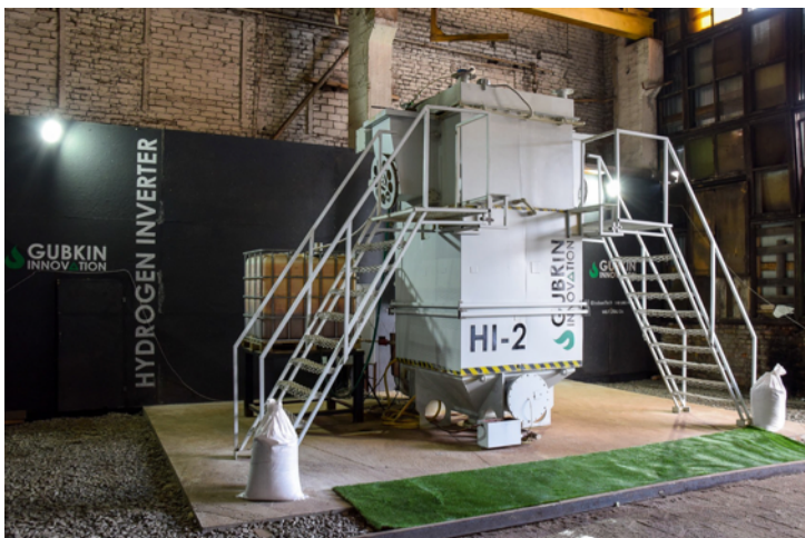
Водородный инвертор, разработанный Карелии может переработать любой материал. Технология отработана на ТБО и опасных медицинских отходах. Сейчас идут испытания, связанные с утилизацией радиоактивных отходов АЭС.
